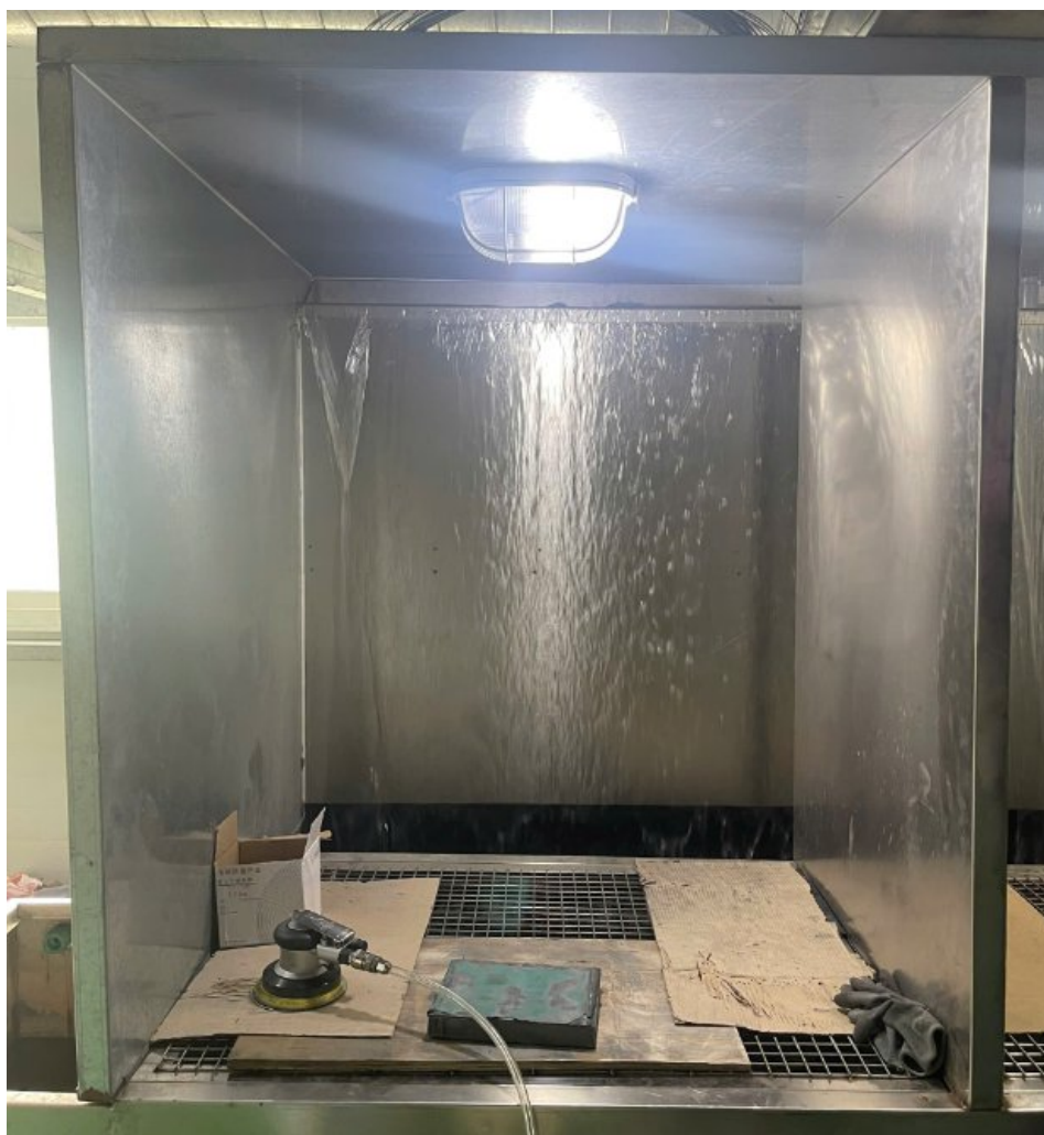
Hình 4.8. Hình ảnh dập bụi màng nước tại KV máy mài
